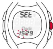
Нажмите кнопку SPEED (+). Значение часов увеличится. При нажатии кнопки PULSE (-) отображаемое значение уменьшится на один час.
