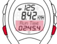
С помощью кнопки PULSE (-) или SPEED (+) выберите функцию для отображения в нижней зоне дисплея.
