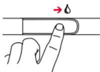
Увлажните зону датчика, которая прилегает к коже. **Важно:** пульс измеряется правильно только в том случае, если зона датчика увлажнена.
