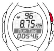
6. Для завершения тренировки нажмите кнопку START/STOP. Секундомер остановится. Для сброса значений на нуль удерживайте кнопку START/STOP нажатой. Для выхода из режима тренировки удерживайте кнопку PULSE (-) нажатой. Более подробное описание пяти шагов см. на следующих страницах.
