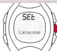
Нажимайте кнопку SPEED (+) до тех пор, пока на дисплее не появится функция «Calibration» (Калибровка).
