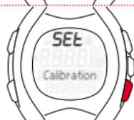
Нажмите кнопку SET. Беговой компьютер RC 1209 рассчитает положение датчика R3 (грудь или бедра) и запустит функцию калибровки. Беговой компьютер RC 1209 проведет пользователя по этапам калибровки.
